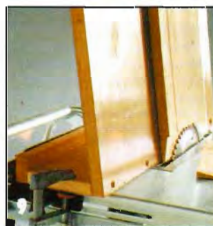
9 Чтобы торцы филенок входили в пазы, их скашивают. Нужный косой срез получают, установив на отрезной стол опорную доску с наклоном на 10°.
