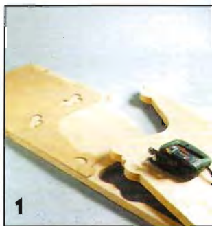
1 Сделав шаблон в масштабе 1:1, электролобзиком вырезают по нему боковые стенки.
