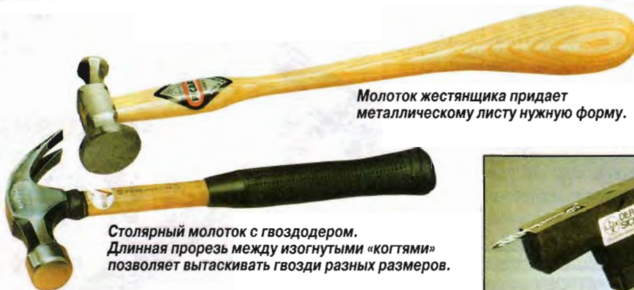
Столярным молотком можно забивать маленькие гвозди в углублениях, не повреждая профиль детали.
