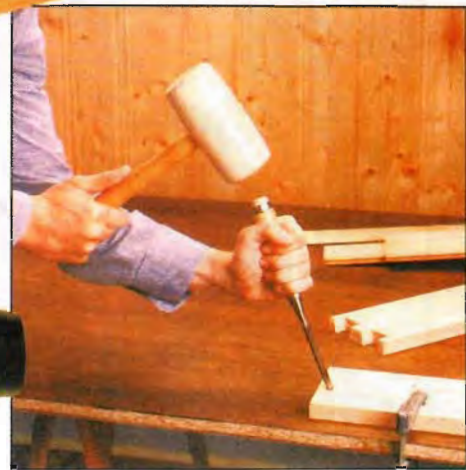
Работа киянкой. Точно рассчитанный по силе удар по стамеске — и шипы готовы.
