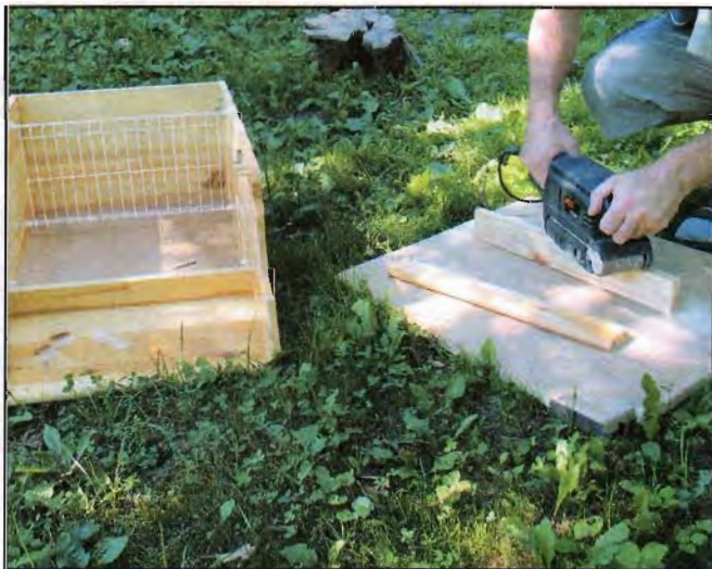
Полку-сушилку пришлось разобрать почти полностью. Плоские простые детали обрабатывал ленточной шлифовальной машинкой. Чтобы убрать черноту, пришлось сошлифовать довольно большой слой древесины.
