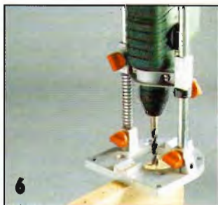
6 При сверлении глухих отверстий используют приспособление с направляющими для дрели.
