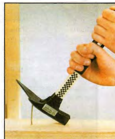
Плотницкий молоток позволяет вытащить из детали самые большие гвозди.
