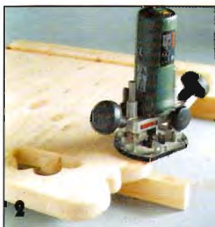
2 Лучший инструмент для скругления кромок — фрезерная машинка с подходящей фрезой. Уголки потом можно довести шлифовальной шкуркой.
