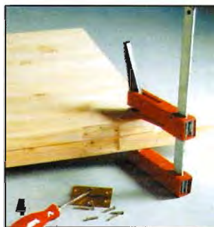
4 Три пары латунных петель врезают в задние кромки рамы сиденья и его крышку заподлицо с поверхностью. Детали стягивают струбцинами, а гнезда под петли выбирают стамеской.
