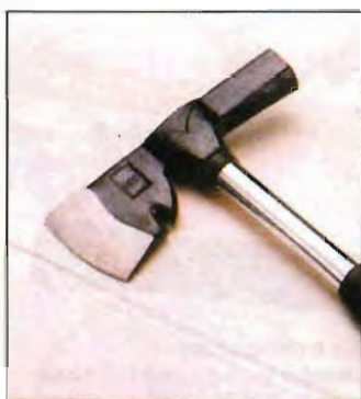
Гипсовый топорик. Лезвием гипс надрезают, а затем обламывают.
