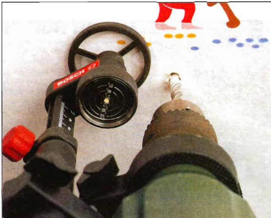
Перпендикулярность отверстия в стене обеспечивает стойка.
