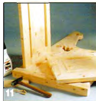
11 Деревянные шканты и столярный клей обеспечат дивану прочность и жесткость. Сначала с одной из боковых стенок соединяют рамы, затем — сиденье и спинку.
