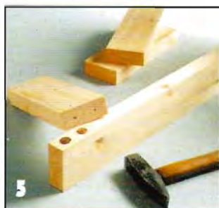
5 Расположение отверстий под шканты на обвязках рам размечают маркерами. Последние вставляют в отверстия, предварительно просверленные в ответных деталях.
