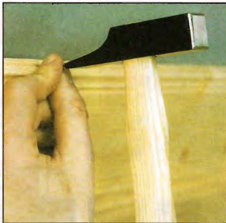
Столярным молотком можно забивать маленькие гвозди в углублениях, не повреждая профиль детали.
